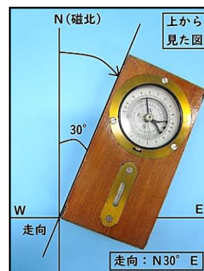
図2 走向の測定の例
