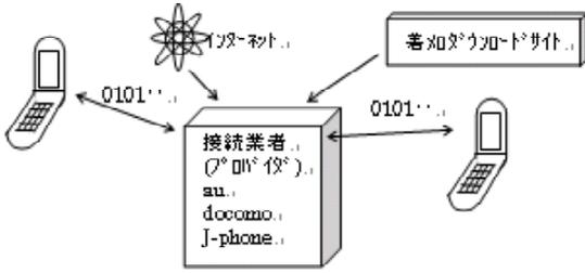
\* パケット単位で送る (例 128byte) 1byte = 8 bit
