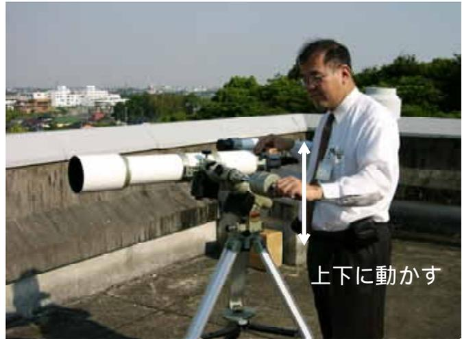
図8 極軸の周りのバランスを取る
