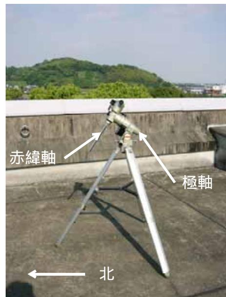
図5 赤道儀式架台の設置
