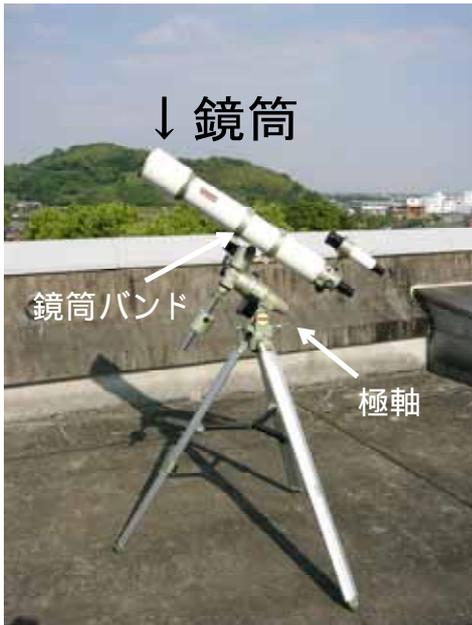
図7 鏡筒を取り付けた状態
