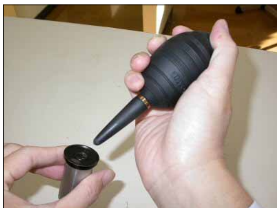
図38 ブLOWERでゴミを吹き飛ばす
