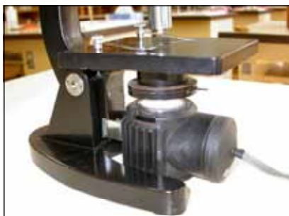
図31 簡易照明装置
