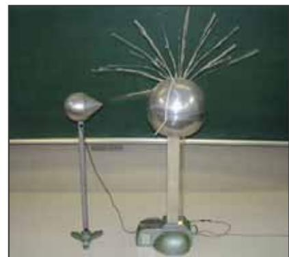
図 9 静電高圧発生装置
