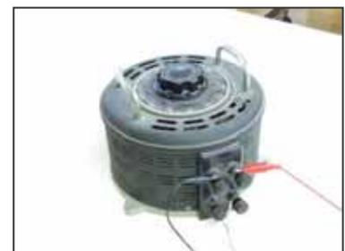
図7 単巻可変変圧器
