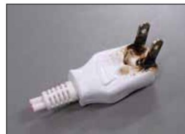
図3 漏電によって溶けたプラグ
