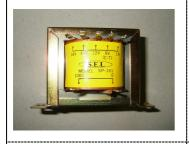
最近では、あまり使用されなくなりましたが鉄芯のコアがある変圧器です。交流(60hz)を加えて電圧を変換し、整流して直流に変えます。
