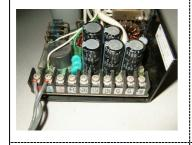
実験用の電源です。スイッチングレギュレータといい、交流を一度直流に変換して、50khz 程度の高い周波数の交流をつくり、さらに直流に変換して出力にします。
