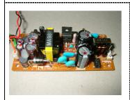
コンピュータの周辺機器で使われている電源です。小さく、軽く、発熱も少ないですが、ノイズを発生するのが欠点です。 コンピュータや通信機器をはじめとする多くの電子機器で使用されています。
