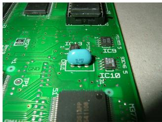
楕円型の水色の部品が、セラミック発振子です。コンピュータに接続するプリンタを制御するためのコンピュータのクロック発生のための部品です。
